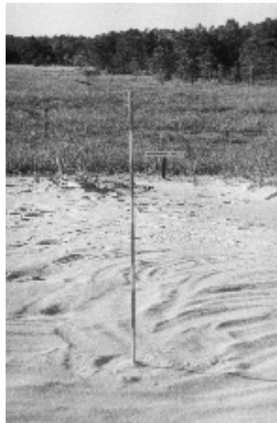
Figuras 6 e 7: As balizas instaladas nas dunas e sua periódica medição
