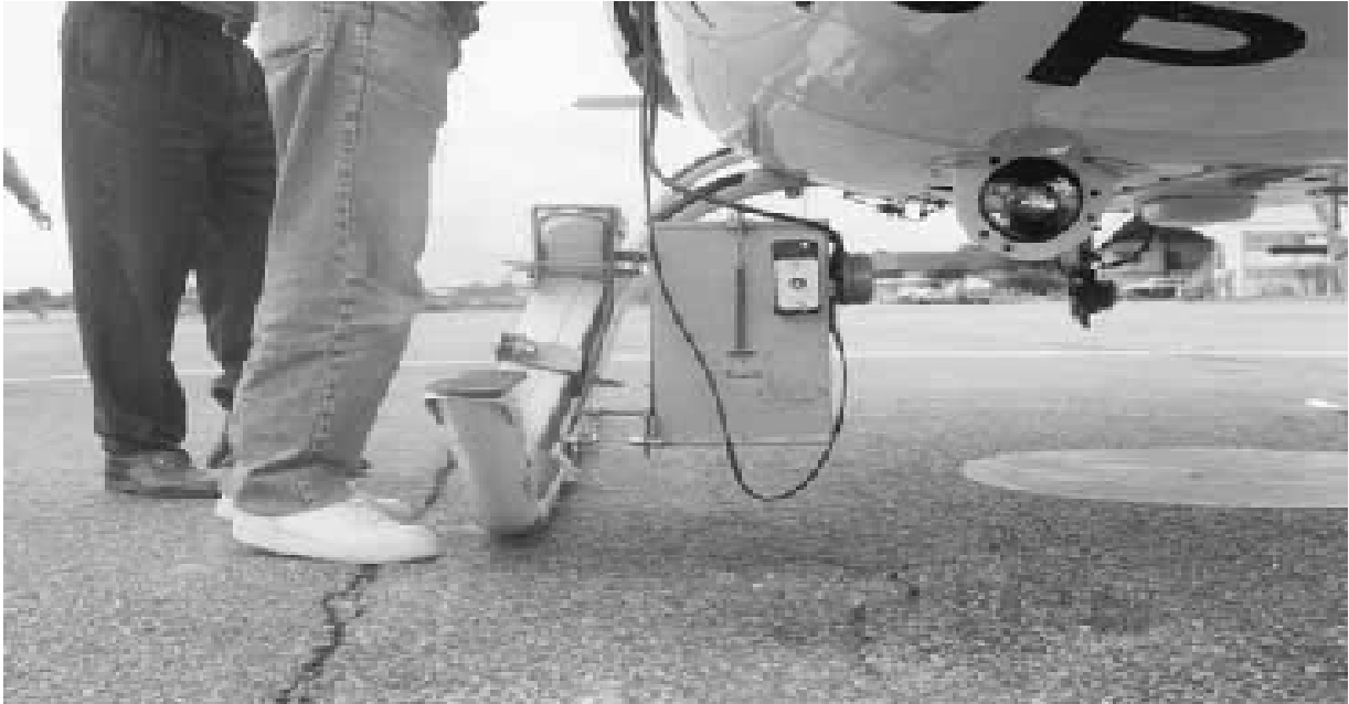
Figura 2- Suporte desenvolvido pela UFV especialmente para realizar as fotografias aéreas na Ilha Rei George. Fonte: Francelino et al, 2004.
