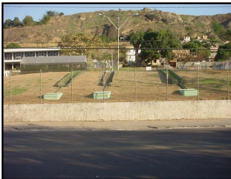
Figura 1: Estação Experimental de Erosão, com as parcelas interligadas às caixas coletoras de sedimentos.
