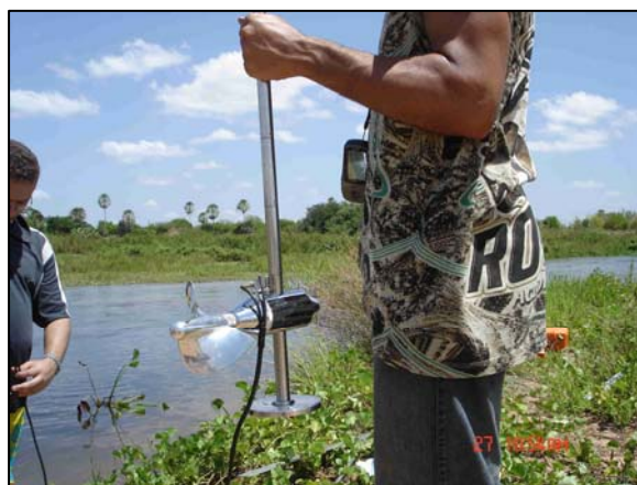
Figura 03 – Molinete utilizado para as Medições de vazões
