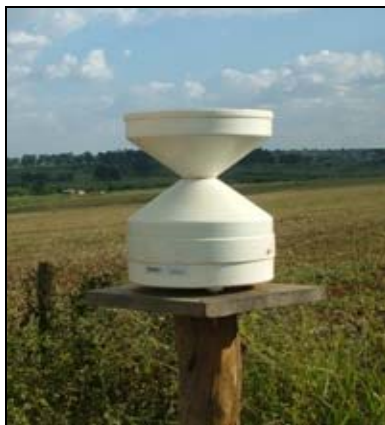
Figura 05 - Pluviômetro digital instalado na estação experimental. Foto: PINESE, J. F. J.
