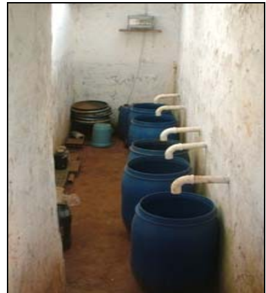
Figura 07 - Tambores de coleta do escoamento superficial. Foto: PINESE, J. F. J.
