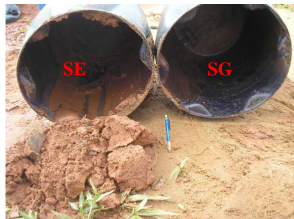
Figura 05 – Diferença na produção de sedimentos nas parcelas com solo exposto e solo com geotêxteis sem a vegetação. Autoria: BEZERRA, J.F.R, 24.11.2005
