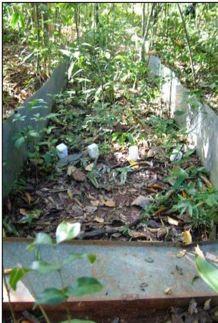
**Figura 03:** Visão frontal da parcela com cobertura de mata e calha coletora de sedimentos. Foto: PINESE, J. F. J.
