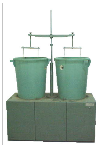
FIGURA 1– Aparelho de Yoder, utilizado para a determinação de os agregados via úmida.
