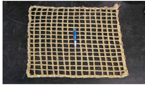
Figura 03 – Biotêxtil confeccionada com fibra de buriti Autoria: BEZERRA, J.F.R, 05.07.05
