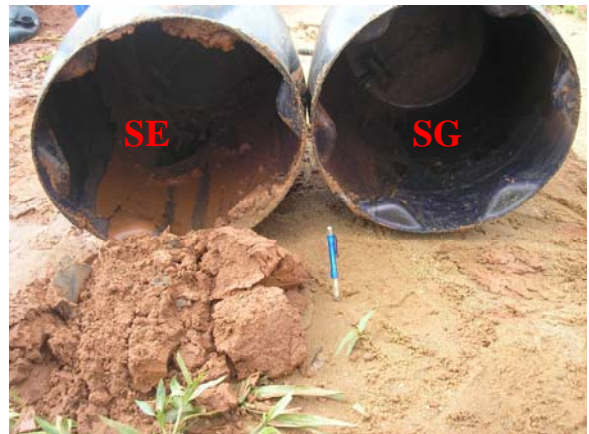
Figura 10 – Diferença na produção de sedimentos nas parcelas com solo exposto e solo com geotêxteis sem a vegetação. Autoria: BEZERRA, J.F.R, 24.11.2005
