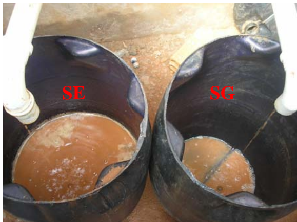
Figura 09 – Diferença na geração do escoamento nas parcelas solo exposto e solo com geotêxteis sem a presença de vegetação. Autoria: BEZERRA, J.F.R, 25.11.05
