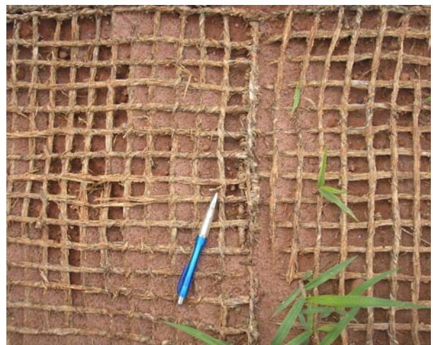
Figura 12 – Retenção de sedimentos nas geotêxteis. Autoria: BEZERRA, J.F.R, 24.11.2005
