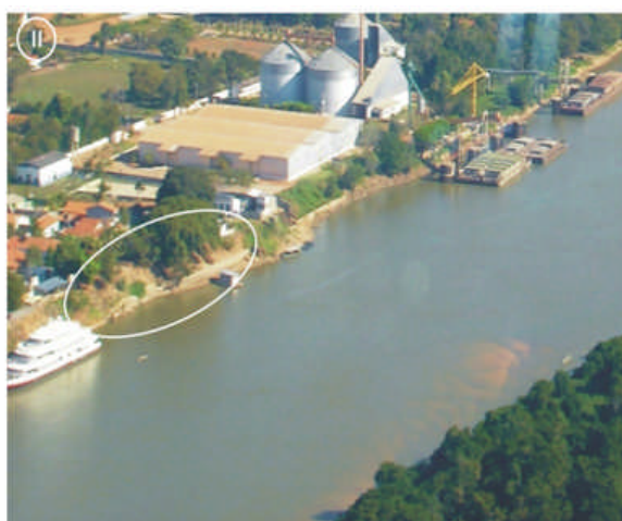
Figura 04- Fotografia oblíqua da área de estudo, evidenciando o recuo da margem do rio, do lado direito tem-se o porto de embarque de mercadorias da Hidrovia Paraguai-Paraná. Silva (2007).
