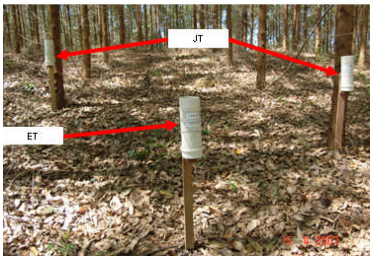
Figura 03 – Disposição dos pluviômetros junto ao tronco (JT) e entre os troncos (ET).
