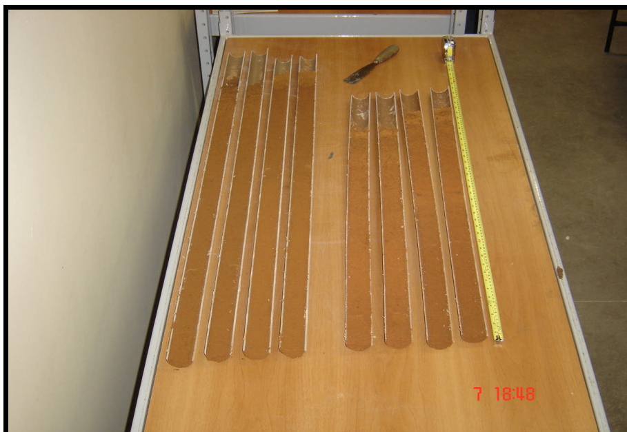
Figura 4: Análise morfooscópica feita a partir da abertura dos testemunhos. À esquerda testemunhos retirados no ponto um e a direita no ponto dois. Fotografia: Nina Simone Vilaverde Moura Fujimoto (2006).
