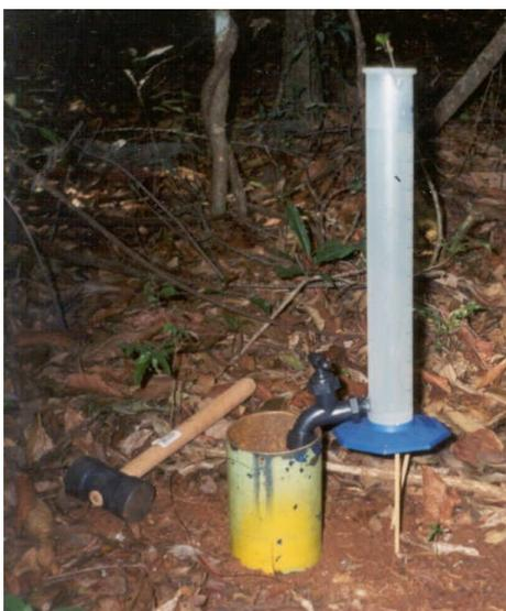
**Figura: 1.** Infiltrômetro de disco utilizado para as medições
