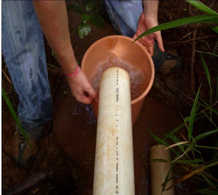
**Figura 4:** Coleta de vazão em área de Voçoroca
