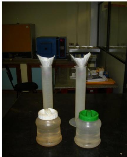
**Figura 6:** Filtragem de Sedimentos
