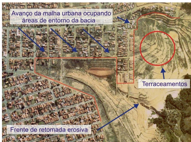
Fig. 01 – Fotografia aérea do ano de 2000 – Ocupação da área da bacia do córrego Tucunzinho e retomada erosiva sobre as obras ali implantadas
