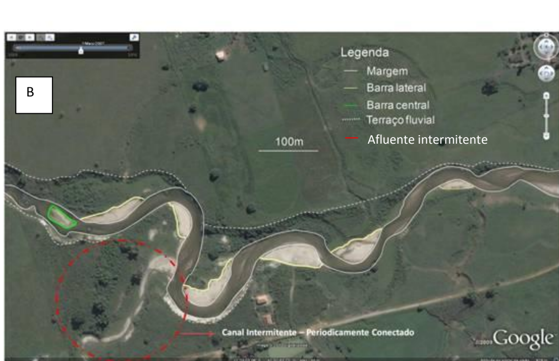
Figura 5: Ajuste lateral do rio são pedro através da erosão e desbarrancamento das margens côncavas. A) 14/08/2003; B) 01/05/2007. fonte: google earth
