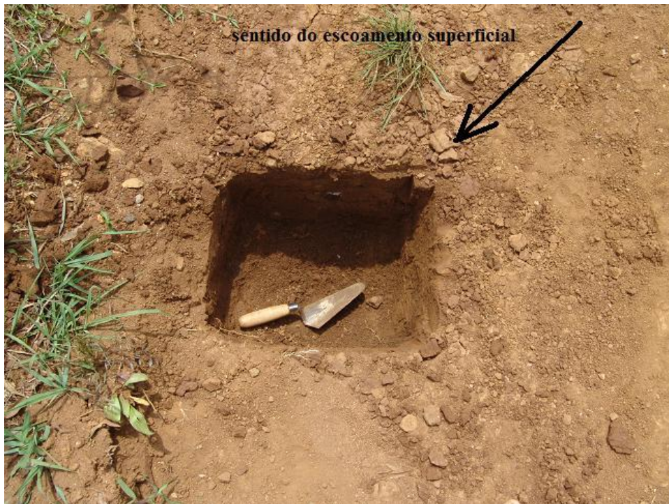
Figura 2 – Armadilha para coleta de materiais nos pontos de entrada para o canal fluvial (cruzamento estrada/estradas). Foto: Dias, W. A. et al. 2010.
