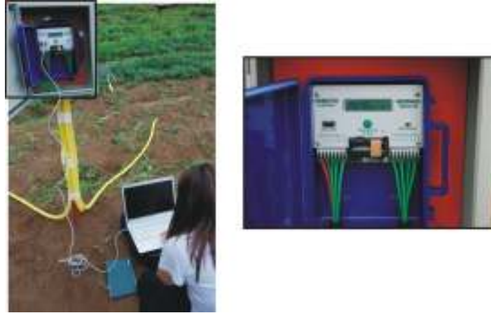
Figura 3: Visão geral do sistema de aquisição de dados em campo, com destaque para o datalogger.
