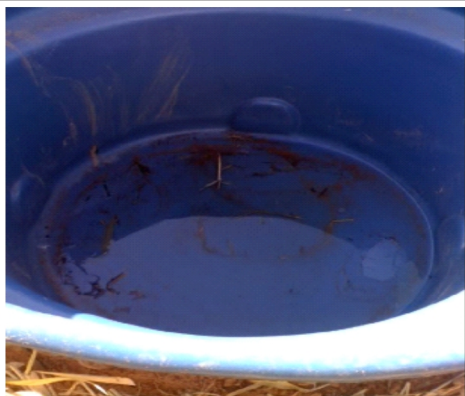
Fig. 6. Tanque de sedimentação da parcela com cobertura vegetal. Foto do autor (2008).
