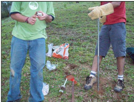
**Figura 3:** Da esquerda para a direita, anel volumétrico preenchido pelo solo após coleta e tradagem com o trado holandês (Hugo Alves S. Loureiro, 2009).
