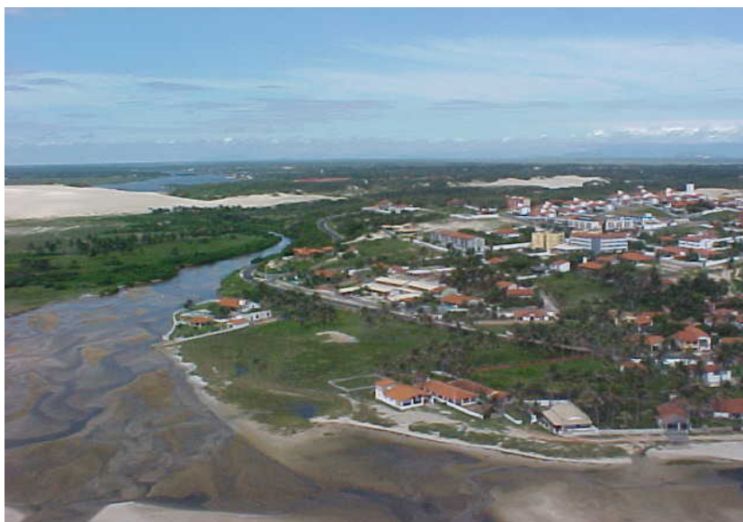
Figura 2. Migração lateral do canal estuarino na direção dos equipamentos urbanos na localidade de praia de Aquiraz.
