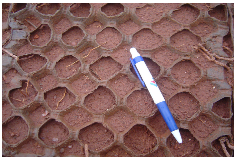
Fig. 7 – Sedimentos retidos nos interstícios da geomanta Fonte: CAMPOS, 2008.
