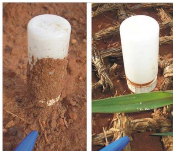
**Figura 04:** Diferença da ação do *splash erosion* nas parcelas solo exposto e solo com geotêxteis.
