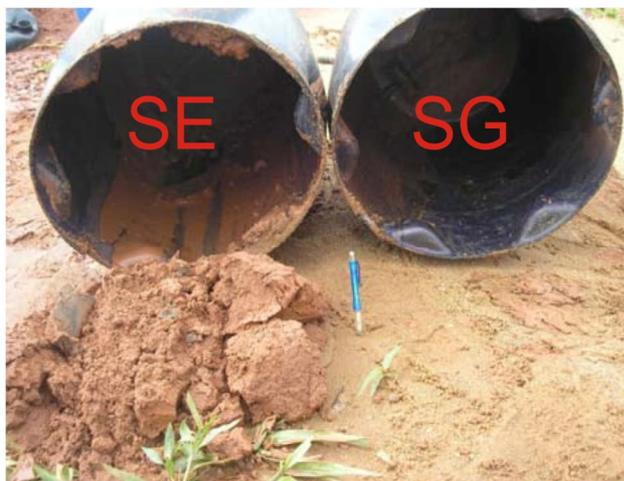
**Figura 03:** Diferença na produção de sedimentos nas parcelas com solo exposto e solo com geotêxteis.
