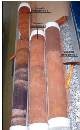
Figura 12: Depósitos tecnogênicos coletados durante a realização do trabalho. Foto da autora (2009).
