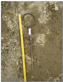
**Fig. 5**: Ilustração da primeira estação de coleta de dados. **A** – Detalhe do aparelho resistivímetro utilizado, onde observa-se o computador acoplado ao multimetro (**a**) para medição da corrente elétrica e da voltagem, baterias (**b**) para gerar a corrente elétrica e amplificador de corrente (**c**) para amplificar a corrente gerada pelas baterias; **B** – eletrodo medindo 16 cm a partir da alça (Fotos: S.L.S. SILVA, 2009).
