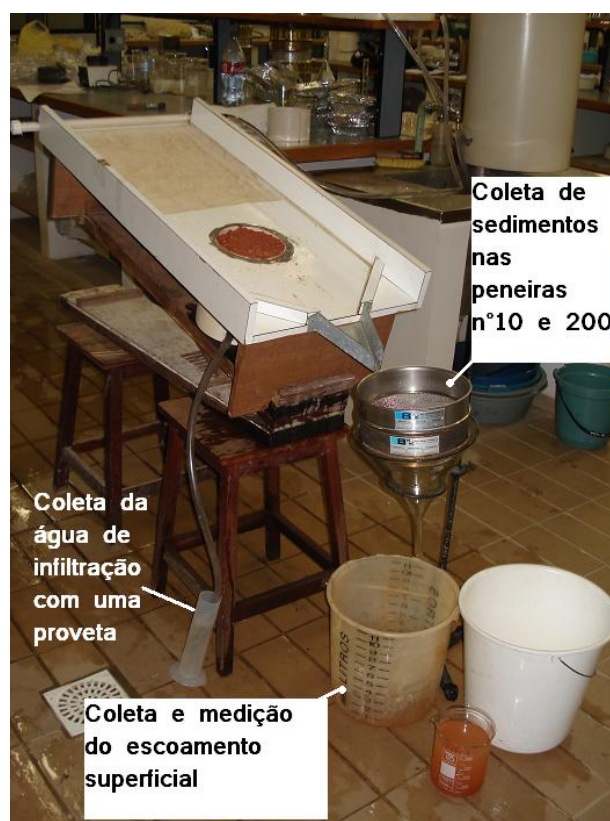
Figura 5 - Equipamento para realização do ensaio de Inderbitzen.
