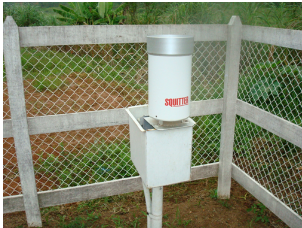
Figura 2: Pluviômetro Digital utilizado na área de estudo
