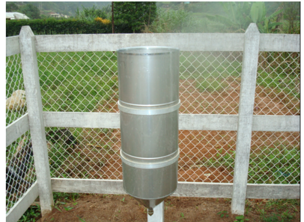
Figura 2: Pluviômetro Digital utilizado na área de estudo
