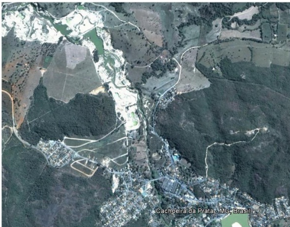
Figura 01: Imagem orbital de trecho do Ribeirão dos Macacos, nas proximidades da cidade de Cachoeira da Prata – MG. Os empreendimentos de extração de areia se destacam na imagem pela coloração esbranquiçada. Observe a organização espacial das cavas ao longo de larga faixa que ocupa as margens esquerda e direita do canal fluvial (várzeas), bem como a proximidade das atividades extrativas da área urbanizada.
